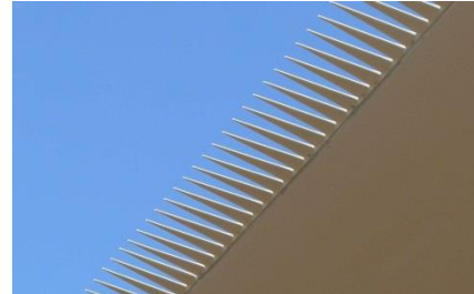
Photographies d'une pale dotée d'un système STE (peigne / dentelure)
