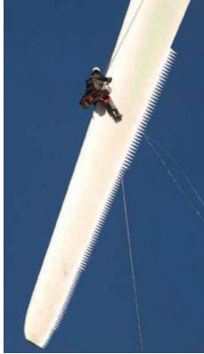
Photographies d'une pale dotée d'un système STE (peigne / dentelure)
